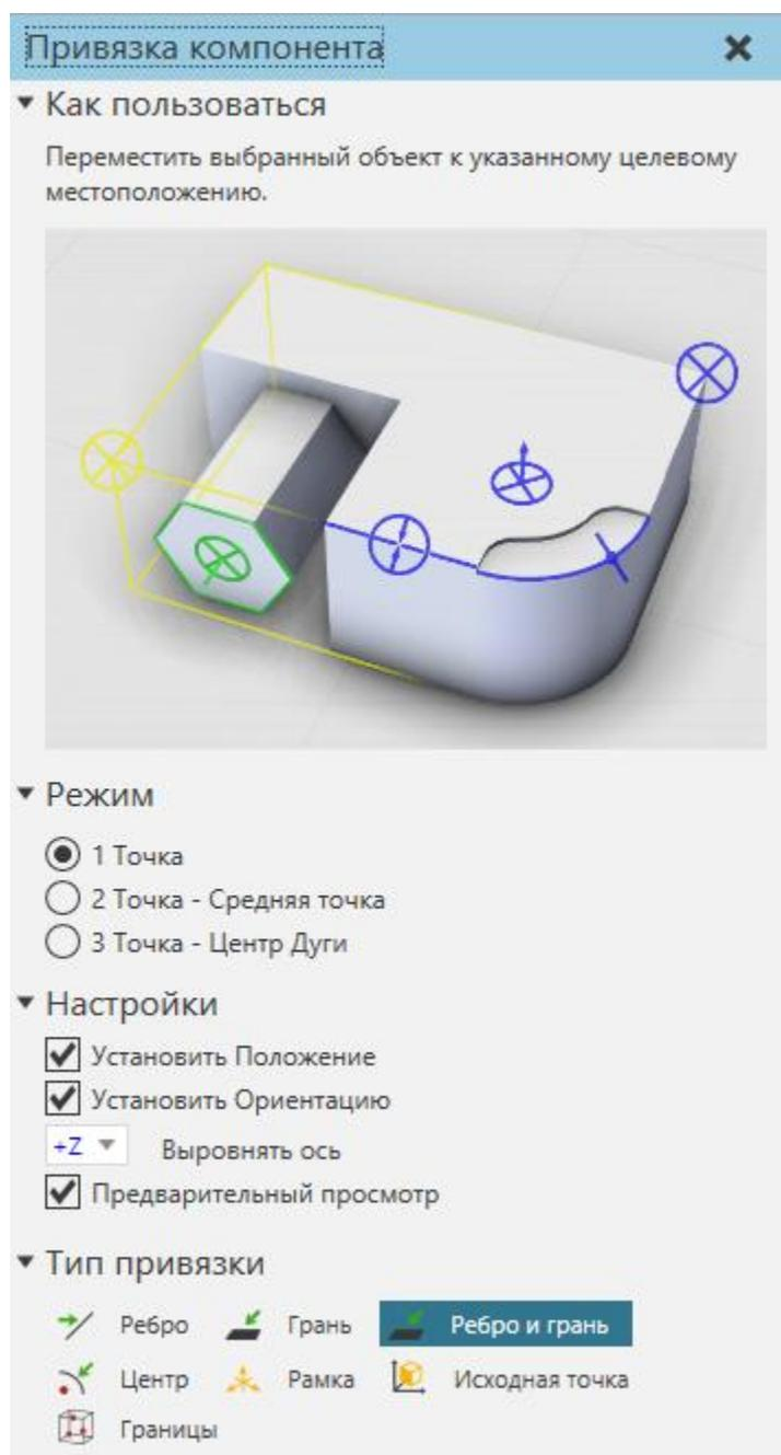
Примечание: Команды Привязка (Snap) и Выровнять (Align) работают так же, как и на главной вкладке, за исключением того, что вы привязываете активную TCP текущего робота.
