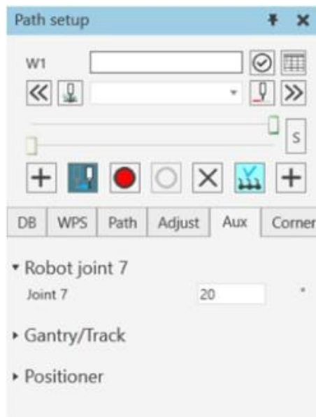
Рисунок 41 – Модификатор Robot Joint 7 на вкладке Aux
